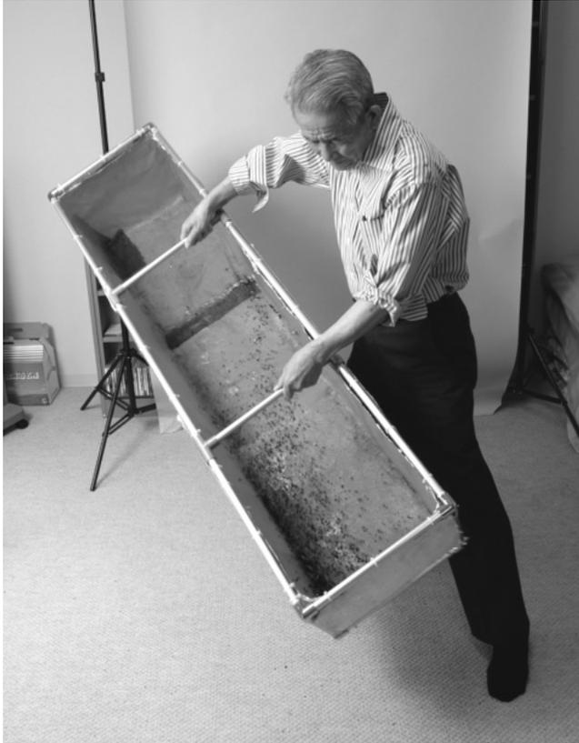
写真2 南作成の「波ざる」(材質は竹ではなくアルミパイプと金網)
